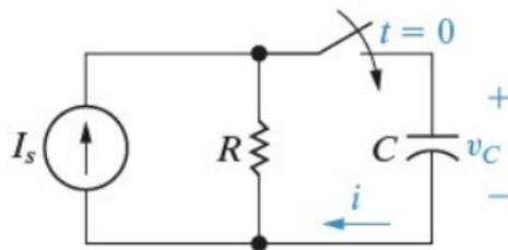
A resposta de um circuito à **aplicação repentina de uma fonte de tensão ou corrente constante** é denominada **resposta a um degrau**
