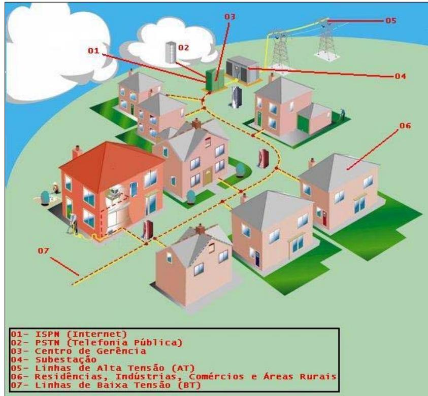
Figura 2.7: Interconexões no projeto PLC da Iguazu Energia
