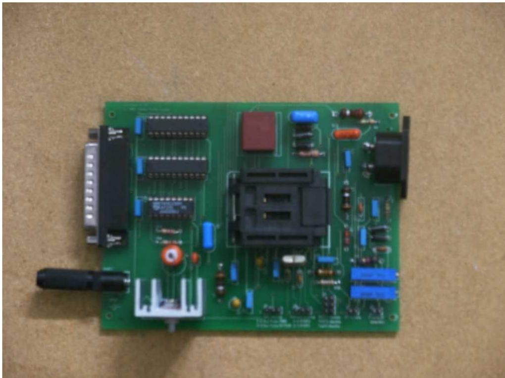
Figura 2.1: Foto do protótipo do modem PLC.
